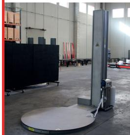
Máquina fabricada en acero INOX 304 para ambientes corrosivos
