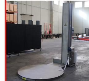
Máquina fabricada en acero INOX 304 para ambientes corrosivos
