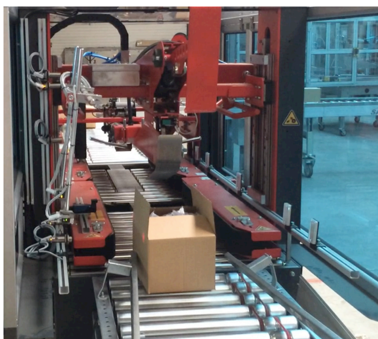
iP45 con ajuste dimensional automático
